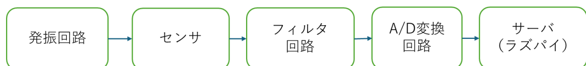
図 1. 浸水センサシステムのブロック図
